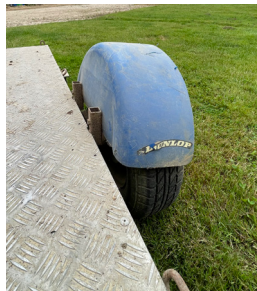
Garde-boue réalisé avec des fûts
