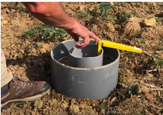
Verser un volume d'eau prédéfini (1 litre par exemple) et mesurer le temps nécessaire pour que le niveau d'eau revienne au niveau de référence défini. Ce temps correspond au temps nécessaire pour infiltrer le volume versé.
