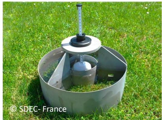
Les deux tubes de PVC sont enfoncés dans le sol sur 5 cm environ. L'anneau extérieur est alimenté en eau régulièrement pour obtenir un niveau d'eau constant, afin que l'humidité sature le sol en eau latéralement. Saturer le sol en eau, permet d'obtenir un état initial correct où il sera alors possible de mesurer l'infiltration verticale qui va avoir lieu dans le tube centrale (15 cm).
