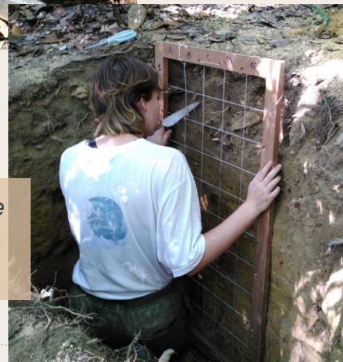
Placement du cadre et dégagement des racines
