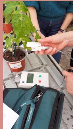
Mesures avec le poromètre
