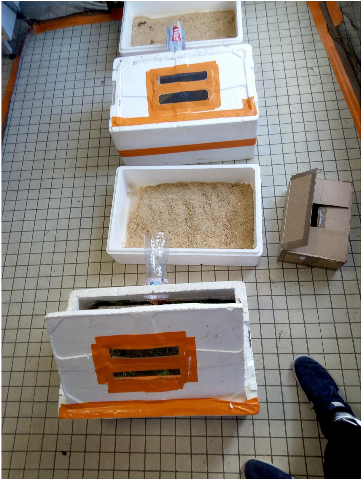
Figure 4: Bacs en polystyrène pour contenir le Compost
